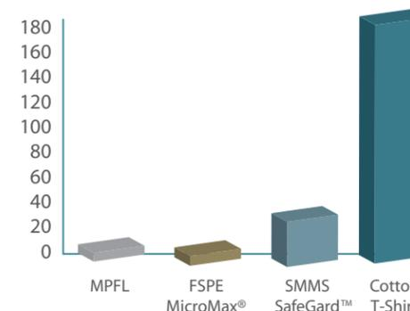
Le MPFL et le FSPE n'ont presque aucune perméabilité à l'air. Le SMMS (SafeGard™) a une perméabilité à l'air plus de dix fois supérieure. Pour assurer le confort, SafeGard™ est le choix supérieur.
