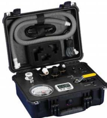
**Level A 防化服气密性检测套装**
